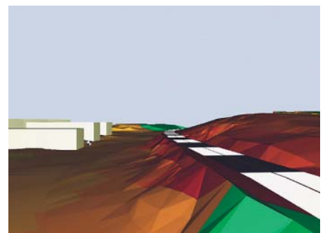
Figur 5: 3D-terrängmodell i CadnaA med järnvägsspår och skolbyggnad för beräkning av järnvägsbullret mot skolan.
